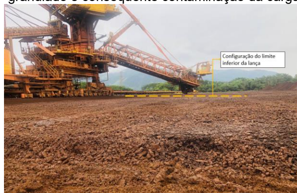
Figura 04 – Etapa de configuração do novo limite inferior da lança para evitar a recuperação do granulado e consequente contaminação da carga
