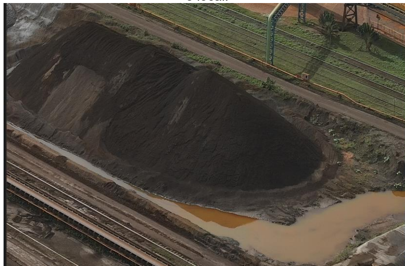
Figura 08 - Pilha sobre cama de granulado durante período chuvoso, sem contato direto com a água o local.
