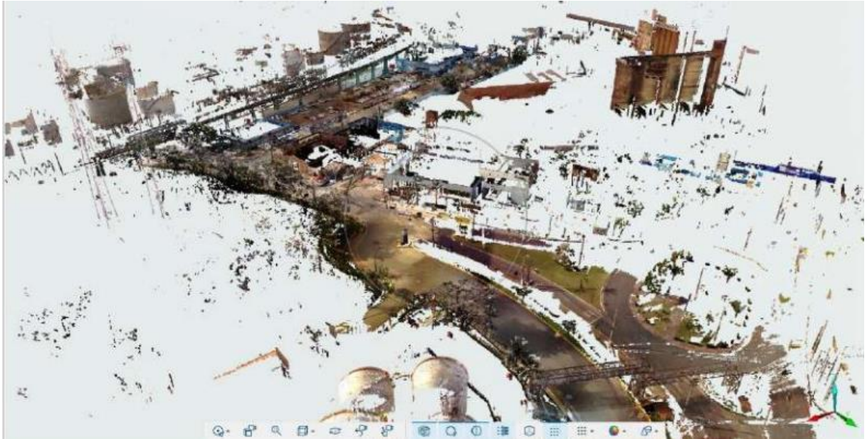
Figura 55 – Escaneamento 3D – Porto do Itaqui Fonte: Arquivos EMAP
