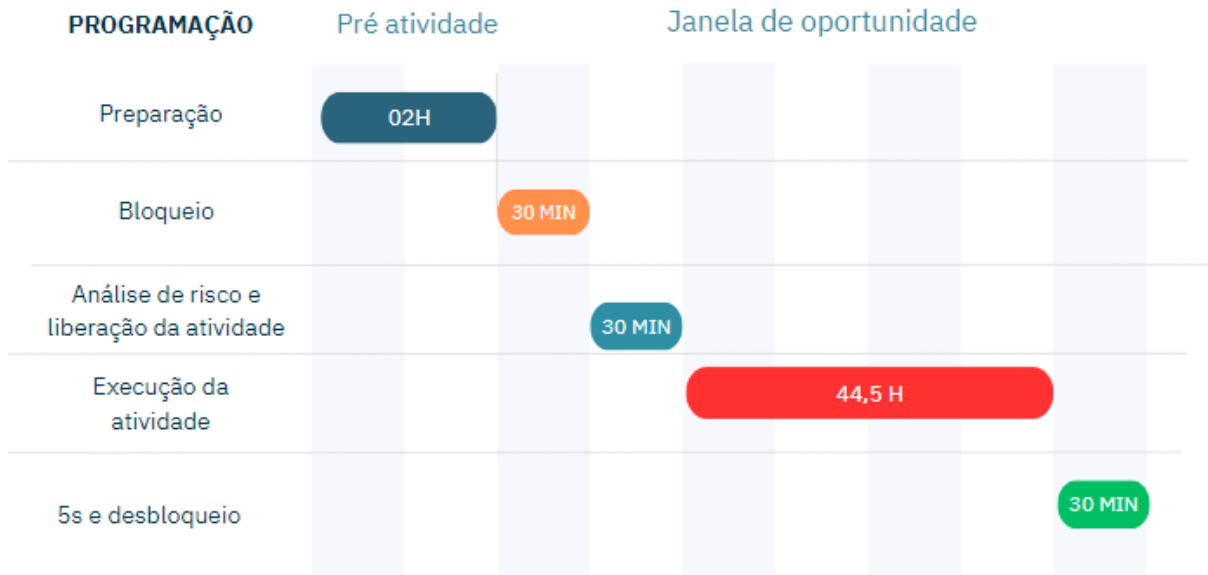
Grande Manutenção de Oportunidade - Representação do Gantt da troca da correia transportadora da TL03.
