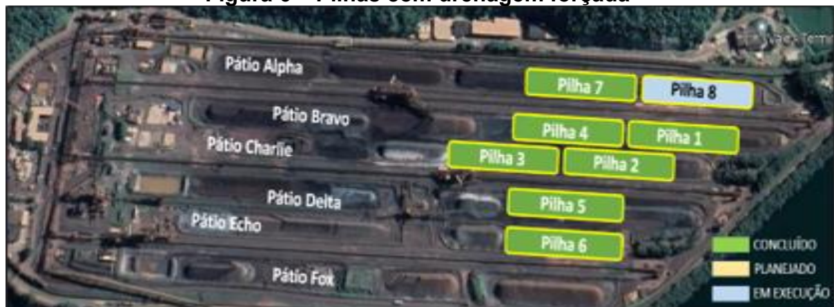
Figura 6 – Pilhas com drenagem forçada
