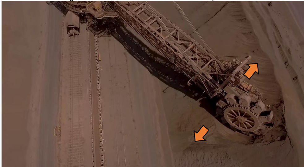
Figura 100 - Movimento de Giro da Recuperadora
