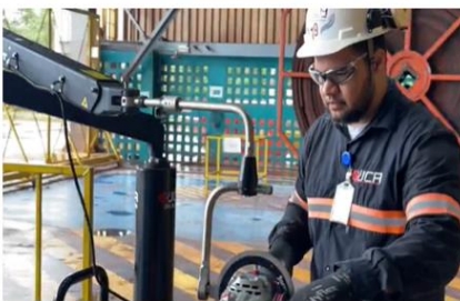
Figura 14 – A Aquisição do braço gravitacional melhorando as condições ergonômicas
