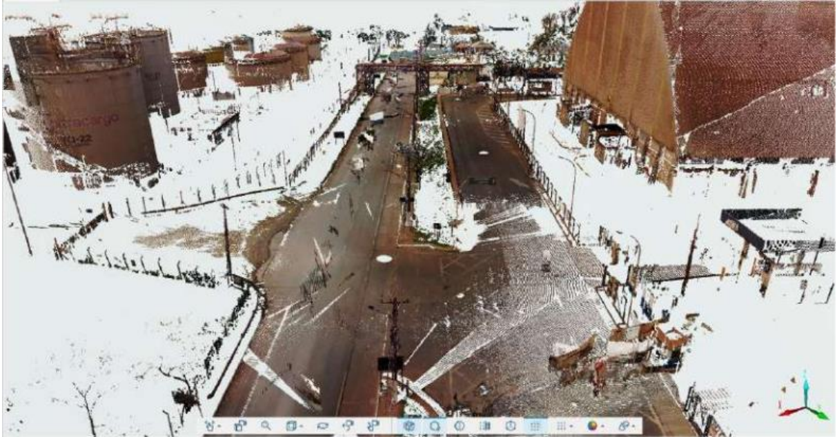
Figura 57 - Escaneamento 3D – Porto do Itaqui Fonte: Arquivos EMAP
