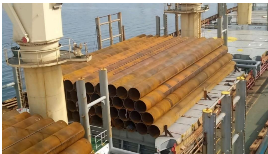
Figura 6 – Alocação de tubos de aço usado em navio breakbulk
